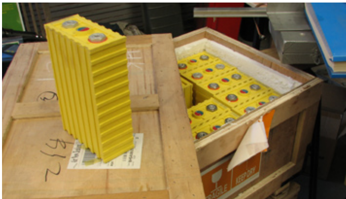
Esta es una celda de litio de 3.2 Volts,. 90 Amp/hr. Pesa solo 3 kg. Compré 38 de ellas
